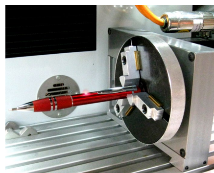
Roterend apparaat voor cilindrische onderdeelmarkering
