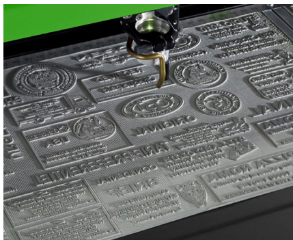
Lasergraveren en snijden van stempels
